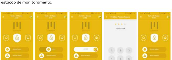
▶ **Desarmamento:** quer o sistema de alarme esteja totalmente ou parcialmente armado, ao desarmá-lo, você deve inserir o PIN de Desarmamento (ou o PIN de Coação, se for este o caso). Para desarmar o sistema, deslize o ícone correspondente em direção ao centro.
